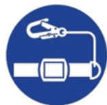
墜落制止用器具使用
