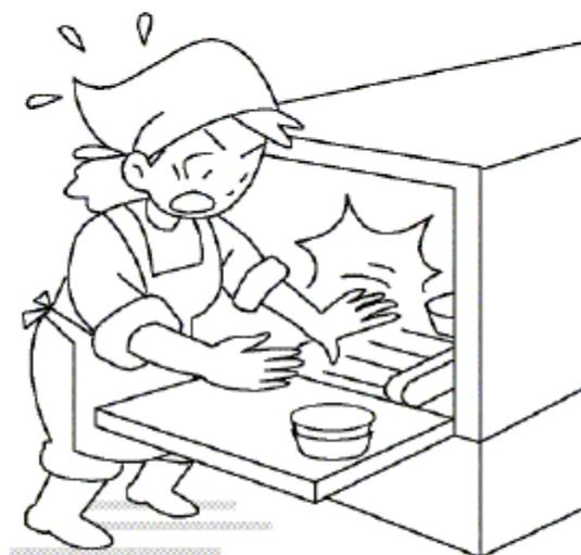
午前 10 時頃、洗浄機による食器の洗浄業務で、洗浄機から出てくる食器を取り、重ねて整理する作業を行う際、洗浄機から出てくる前に食器を取ろうとし、誤って指を回転中のコンベアチェーンにはさまれそうになった。
