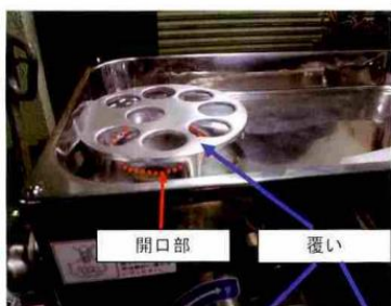
チョッパーの覆い（固定式ガード）の例
