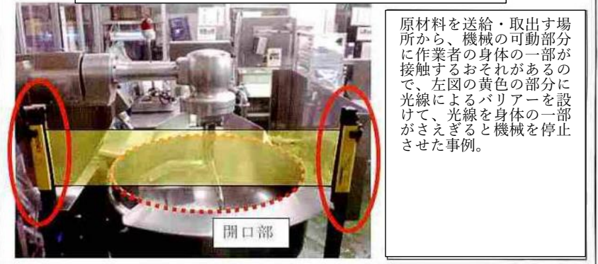
攪拌機に光線式安全装置を取り付けた例
