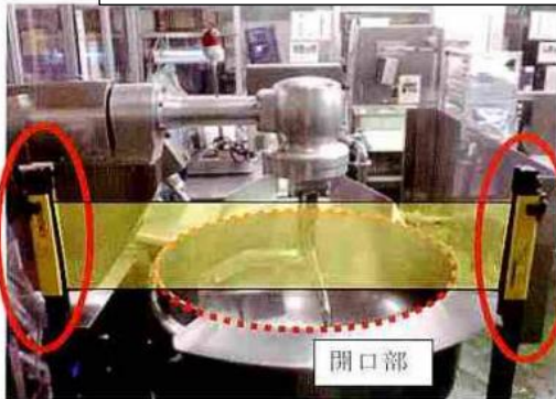
攪拌機に光線式安全装置を取り付けた例
