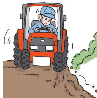
小心容易塌陷的路肩
