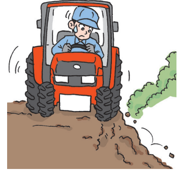
ระมัดระวังขณะขับขึ้นไหล่ทางของถนนที่พังทลายง่าย
