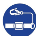
墜落制止用器具使用
