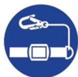
墜落制止用器具使用
